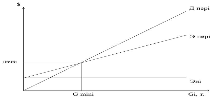
После определения минимального годового объема перевозок грузов рассчитывается коэффициент использования годовой провозной способности судна и минимальные доходы, которые определяют предельно допустимые значения работы судна.
